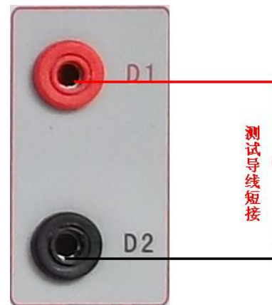
图 23，导线阻值清零接线图
