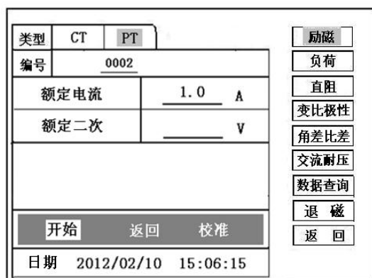
图 25，PT 励磁特性参数设置界面
