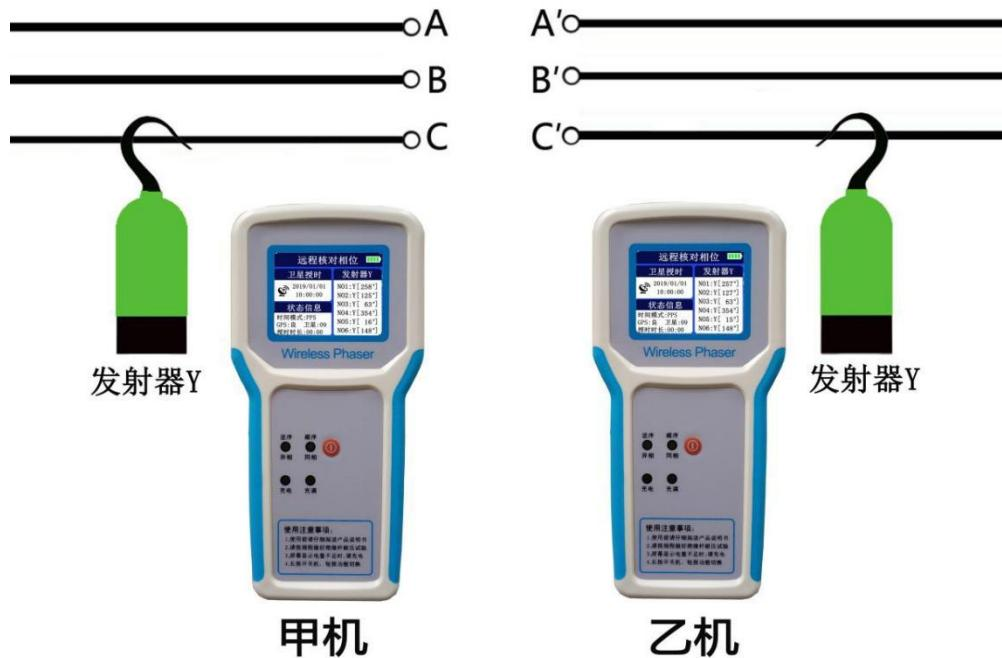
先将两台接收主机开机，切换到远程核相模式，在室外有GPS信号的地方完成授时，直至语音播报发射器无信号。再分别将Y发射器接触所测带电线路，此时两台接收主机每5(10)秒记录一组数据，No1到No6分别为每分钟的0s(30s)、5s(35)、10s(40s)、15s(45s)、20s(50s)、25s(55s)的数据，对比甲乙两机同一编号的数据即可判断同异相。显示界面如下：
