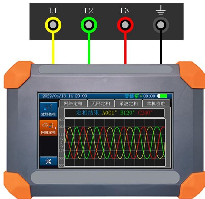
录波定相可用于环网柜带电显示器的定相作业，可直观的给出3条相线的相位结果，并分析测试波形是否有畸变，导致无法准确定相。
