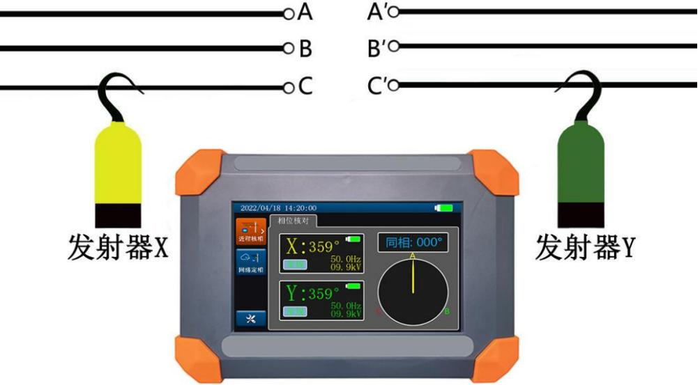
将 X、Y 发射器连接绝缘杆，分别挂接在两条需要核相的线路上，如图所示：发射器 X 挂在线路 1 的 C 相，发射器 Y 挂在线路 2 的 C 相，此时仪器显示“同相”，如发射器 Y 挂在线路 2 的 B 相或者 A 相，仪器会提示“异相”，并显示对应相位差值。
